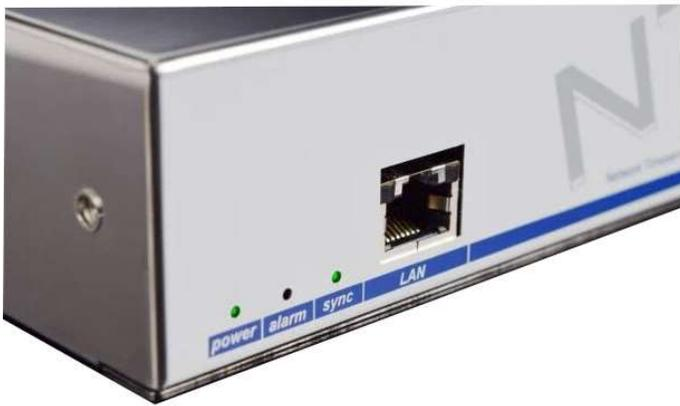
L'NTS è un server di tempo NTP molto performante, nonostante le dimensioni ridotte e costo contenuto. Può essere utilizzato in molteplici realtà per sincronizzare con grande precisione una rete di computer su rete LAN attraverso il protocollo NTP sino a 250 richieste al secondo. Funziona sia come server NTP primario, sia come slave; l'orario può essere sincronizzato attraverso segnale DCF o GPS.
